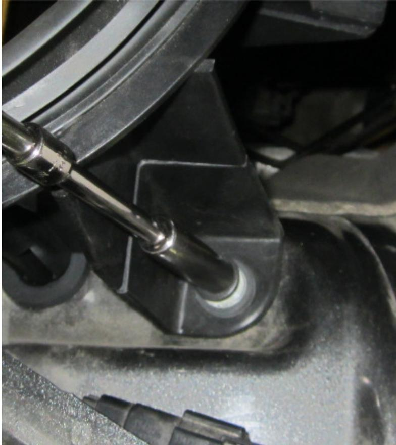
Install retaining bolt.
